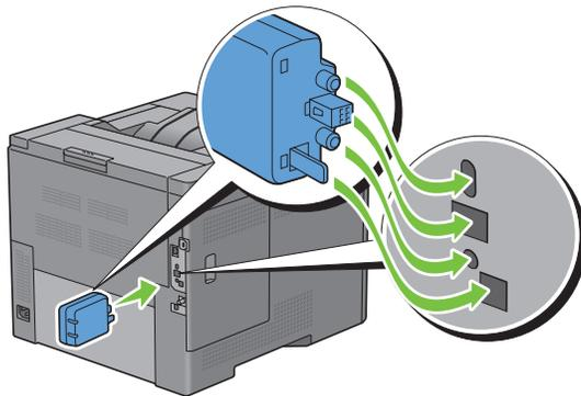
**NOTA:** verificare che l'adattatore sia completamente inserito e fissato.
