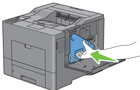
**⚠ ATTENZIONE:** se il contenitore toner di scarto non riesce a fissarsi adeguatamente nella posizione corretta, è necessario accertarsi che la cartuccia del tamburo sia inserita completamente (vedere il passaggio precedente).
