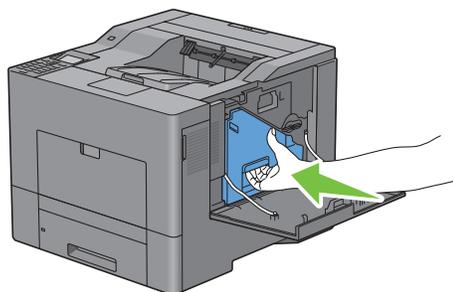
**10** Ruotare di 90 gradi in senso orario la leva del contenitore toner di scarto per bloccarlo.
