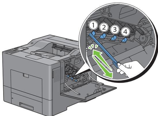
**7** Ripetere il passo 6 per gli altri tre fori. È sufficiente inserire l'asta una sola volta in ogni foro.
